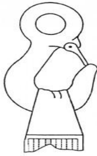
Zobrazenie znázorňuje nevyhovujúce zavesenie oka popruhu na háku s príliš malým polomerom.
