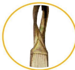
POŠKODENIE UV ŽIARENÍM
